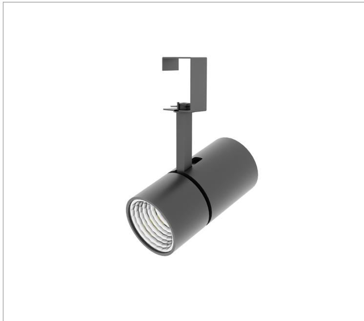
Luminária para perfilado, 20W 3000K IRC>95. Corpo em alumínio. Acabamento Branca, Preta ou Especial. Controle óptico principal através de refletor facho 24°. Luminária grau de proteção IP-20. Driver corrente constante Liga/Desliga, Triac, 1-10V ou Dali (consultar condições). Tensão de trabalho 220V ou Bivolt.
