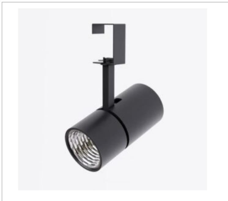
Luminária para perfilado, 28W 2700K IRC>80. Corpo em alumínio. Acabamento Branca, Preta ou Especial. Controle óptico principal através de refletor facho 24°. Luminária grau de proteção IP-20. Driver corrente constante Liga/Desliga, Triac, 1-10V ou Dali (consultar condições). Tensão de trabalho 220V ou Bivolt.
