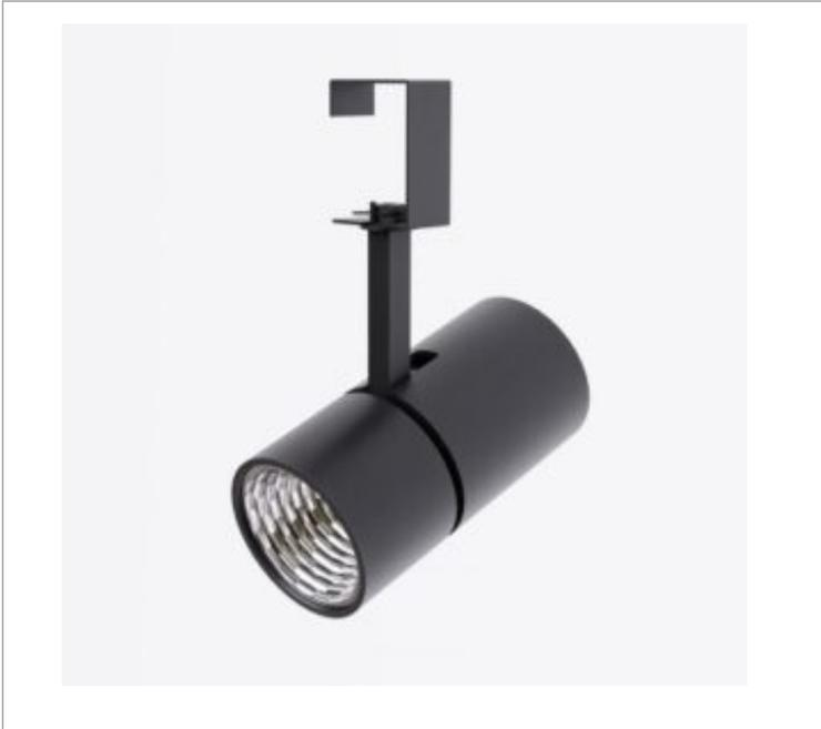
Luminária para perfilado, 7W 2700K IRC>80. Corpo em alumínio. Acabamento Branca, Preta ou Especial. Controle óptico principal através de refletor facho 40°. Luminária grau de proteção IP-20. Driver corrente constante Liga/Desliga, Triac, 1-10V ou Dali (consultar condições). Tensão de trabalho 220V ou Bivolt.
