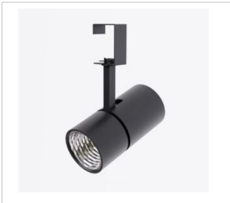
Luminária para perfilado, 28W 3000K IRC>90. Corpo em alumínio. Acabamento Branca, Preta ou Especial. Controle óptico principal através de refletor facho 60°. Luminária grau de proteção IP-20. Driver corrente constante Liga/Desliga, Triac, 1-10V ou Dali (consultar condições). Tensão de trabalho 220V ou Bivolt.
