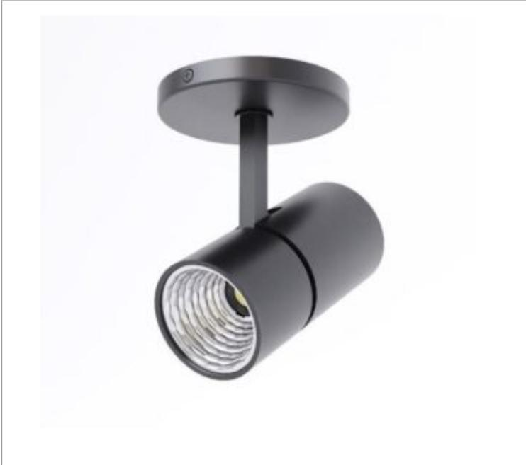
Luminária de sobrepор, 14W 2700K IRC>80. Corpo em alumínio. Acabamento Branca, Preta ou Especial. Controle óptico principal através de refletor facho 24°. Luminária grau de proteção IP-20. Driver corrente constante Liga/Desliga, Triac, 1-10V ou Dali (consultar condições). Tensão de trabalho 220V ou Bivolt.
