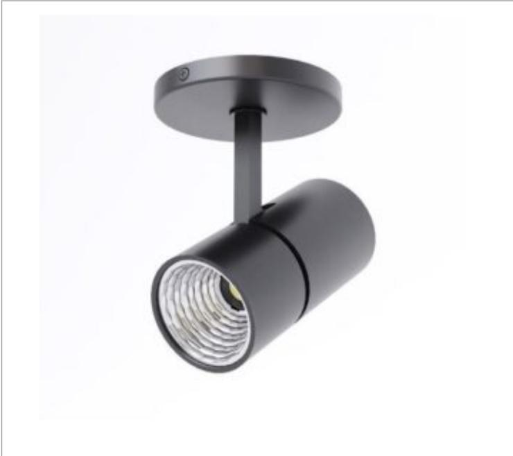
Luminária de sobrepор, 28W 3000K IRC>80. Corpo em alumínio. Acabamento Branca, Preta ou Especial. Controle óptico principal através de refletor facho 40°. Luminária grau de proteção IP-20. Driver corrente constante Liga/Desliga, Triac, 1-10V ou Dali (consultar condições). Tensão de trabalho 220V ou Bivolt.
