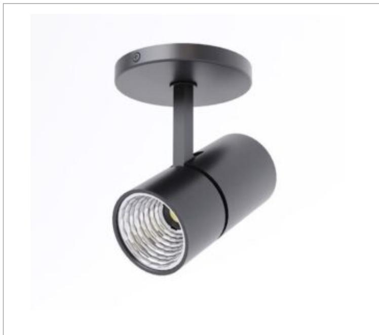
Luminária de sobrepор, 14W 2500K IRC>95. Corpo em alumínio. Acabamento Branca, Preta ou Especial. Controle óptico principal através de refletor facho 60°. Luminária grau de proteção IP-20. Driver corrente constante Liga/Desliga, Triac, 1-10V ou Dali (consultar condições). Tensão de trabalho 220V ou Bivolt.
