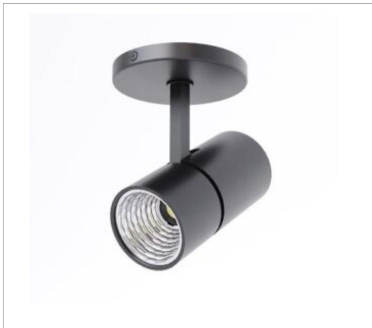
Luminária de sobrepор, 20W 4000K IRC>80. Corpo em alumínio. Acabamento Branca, Preta ou Especial. Controle óptico principal através de refletor facho 60°. Luminária grau de proteção IP-20. Driver corrente constante Liga/Desliga, Triac, 1-10V ou Dali (consultar condições). Tensão de trabalho 220V ou Bivolt.
