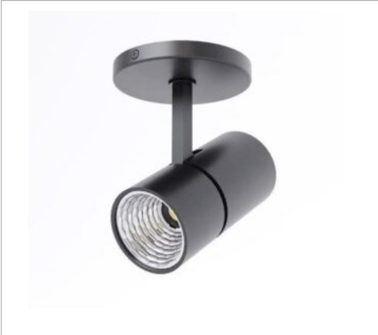
Luminária de sobrepор, 28W 4000K IRC>80. Corpo em alumínio. Acabamento Branca, Preta ou Especial. Controle óptico principal através de refletor facho 60°. Luminária grau de proteção IP-20. Driver corrente constante Liga/Desliga, Triac, 1-10V ou Dali (consultar condições). Tensão de trabalho 220V ou Bivolt.
