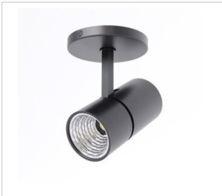
Luminária de sobreporth, 42W 2700K IRC>90. Corpo em alumínio. Acabamento Branca, Preta ou Especial. Controle óptico principal através de refletor facho 60°. Luminária grau de proteção IP-20. Driver corrente constante Liga/Desliga, Triac, 1-10V ou Dali (consultar condições). Tensão de trabalho 220V ou Bivolt.
