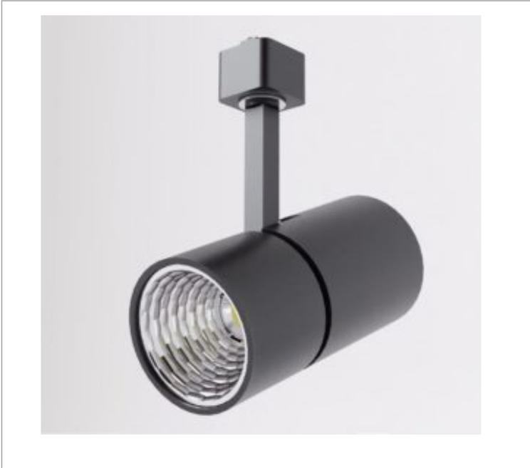
Luminária de trilho, 14W 2500K IRC>95. Corpo em alumínio. Acabamento Branca, Preta ou Especial. Controle óptico principal através de fecho 24°. Luminária grau de proteção IP-20. Driver corrente constante Liga/Desliga, Triac, 1-10V ou Dali (consultar condições). Tensão de trabalho 220V ou Bivolt.
