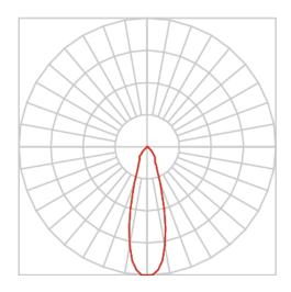
Luminária de trilho, 42W 3000K IRC>90. Corpo em alumínio. Acabamento Branca, Preta ou Especial. Controle óptico principal através de facho 24°. Luminária grau de proteção IP-20. Driver corrente constante Liga/Desliga, Triac, 1-10V ou Dali (consultar condições). Tensão de trabalho 220V ou Bivolt.
