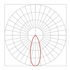
Luminária de trilho, 7W 3000K IRC>95. Corpo em alumínio. Acabamento Branca, Preta ou Especial. Controle óptico principal através de facho 24°. Luminária grau de proteção IP-20. Driver corrente constante Liga/Desliga, Triac, 1-10V ou Dali (consultar condições). Tensão de trabalho 220V ou Bivolt.
