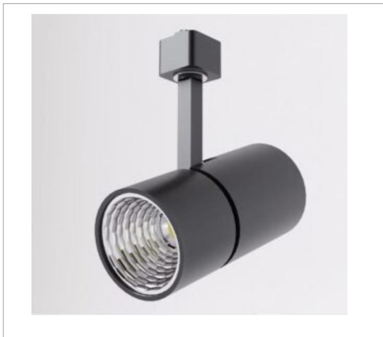
Luminária de trilho, 20W 2500K IRC>95. Corpo em alumínio. Acabamento Branca, Preta ou Especial. Controle óptico principal através de fecho 40°. Luminária grau de proteção IP-20. Driver corrente constante Liga/Desliga, Triac, 1-10V ou Dali (consultar condições). Tensão de trabalho 220V ou Bivolt.
