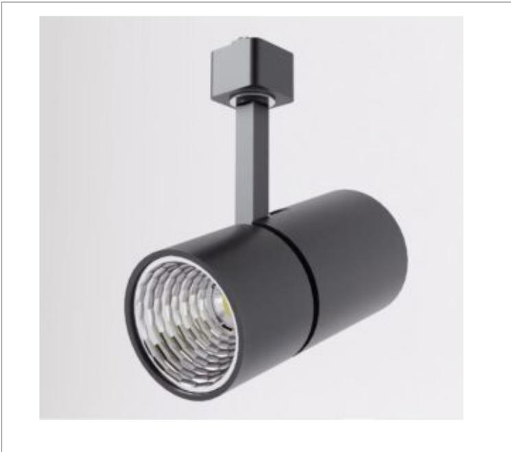
Luminária de trilho, 28W 2700K IRC>90. Corpo em alumínio. Acabamento Branco, Preto ou Especial. Controle óptico principal através de facho 40°. Luminária grau de proteção IP-20. Driver corrente constante Liga/Desliga, Triac, 1-10V ou Dali (consultar condições). Tensão de trabalho 220V ou Bivolt.
