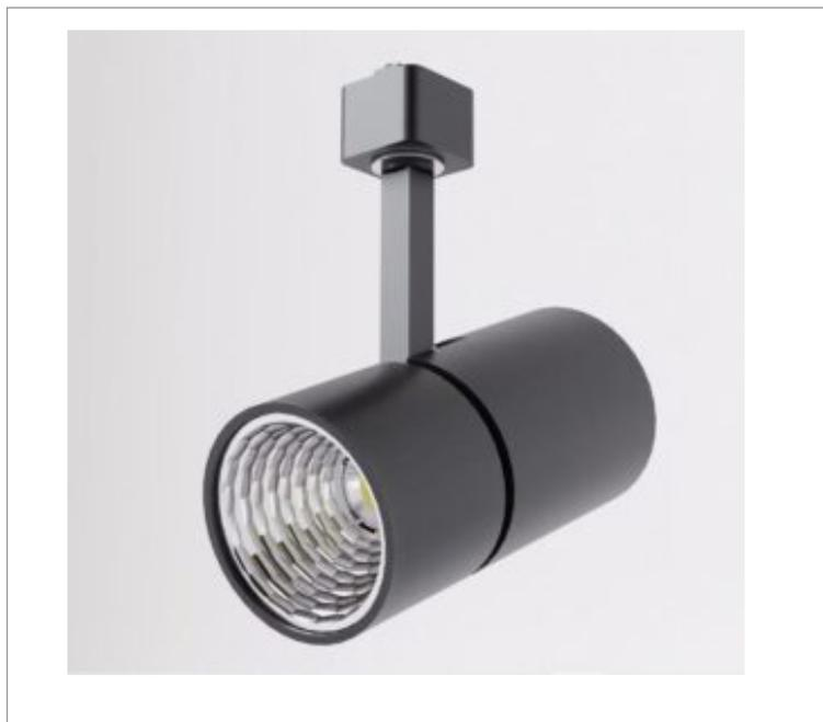
Luminária de trilho, 14W 3000K IRC>90. Corpo em alumínio. Acabamento Branca, Preta ou Especial. Controle óptico principal através de fecho 60°. Luminária grau de proteção IP-20. Driver corrente constante Liga/Desliga, Triac, 1-10V ou Dali (consultar condições). Tensão de trabalho 220V ou Bivolt.
