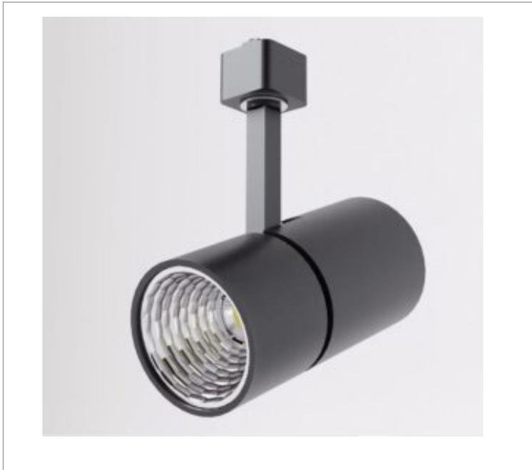
Luminária de trilho, 20W 2500K IRC>95. Corpo em alumínio. Acabamento Branco, Preto ou Especial. Controle óptico principal através de fecho 60°. Luminária grau de proteção IP-20. Driver corrente constante Liga/Desliga, Triac, 1-10V ou Dali (consultar condições). Tensão de trabalho 220V ou Bivolt.
