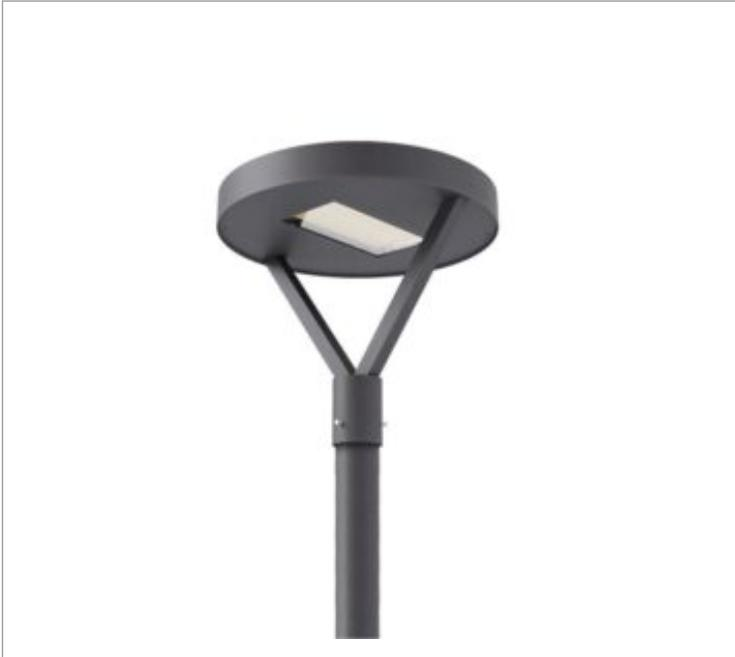
Pétala circular, 25W 3000K IRC>80. Corpo em alumínio. Acabamento Branca, Preta ou Especial. Controle óptico principal através de difusor em policarbonato transparente. Luminária grau de proteção IP-65. Driver corrente constante Liga/Desliga, Triac, 1-10V ou Dali (consultar condições). Tensão de trabalho 220V ou Bivolt.
