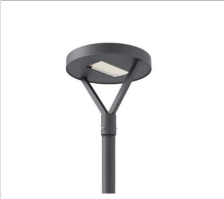
Pétala circular, 25W 6500K IRC>80. Corpo em alumínio. Acabamento Branca, Preta ou Especial. Controle óptico principal através de difusor em policarbonato transparente. Luminária grau de proteção IP-65. Driver corrente constante Liga/Desliga, Triac, 1-10V ou Dali (consultar condições). Tensão de trabalho 220V ou Bivolt.
