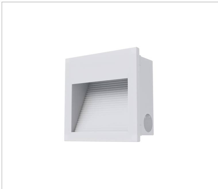
Luminária quadrada, 4W 5000K IRC>80. Corpo em alumínio. Acabamento Branca, Preta ou Especial. Controle óptico principal através de refletor fecho assimétrico. Luminária grau de proteção IP-20. Driver corrente constante Liga/Desliga Tensão de trabalho 127V ou 220V.
