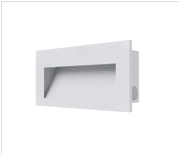
Luminária retangular, 8W 3000K IRC>80. Corpo em alumínio. Acabamento Branca, Preta ou Especial. Controle óptico principal através de refletor fecho assimétrico. Luminária grau de proteção IP-20. Driver corrente constante Liga/Desliga Tensão de trabalho 127V ou 220V.
