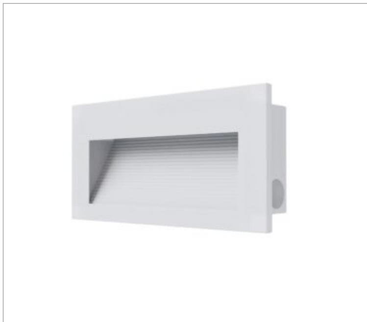
Luminária retangular, 8W 4000K IRC>80. Corpo em alumínio. Acabamento Branca, Preta ou Especial. Controle óptico principal através de refletor fecho assimétrico. Luminária grau de proteção IP-20ou65 (consultar condições). Driver corrente constante Liga/Desliga Tensão de trabalho 127V ou 220V.
