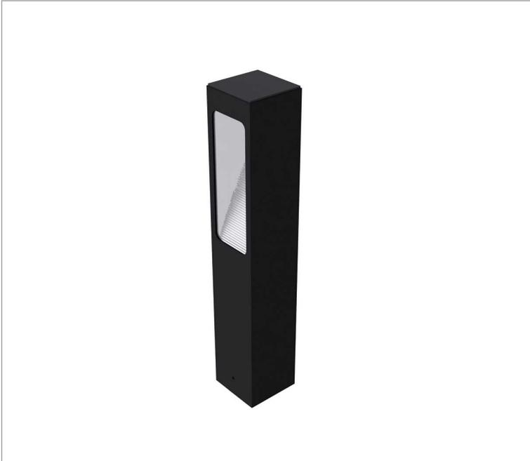
Pétala quadrada, 4W 5000K IRC>80. Corpo em alumínio. Acabamento Branca, Preta ou Especial. Controle óptico principal através de refletor fecho assimétrico. Luminária grau de proteção IP-65. Driver corrente constante Liga/Desliga Tensão de trabalho 127V ou 220V.
