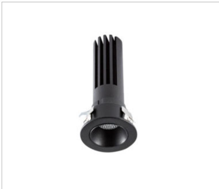
Luminária circular de embutir em forro de gesso, 5W 3000K IRC>90. Corpo em alumínio. Acabamento Preta. Controle óptico principal através de refletor facho 36°. Luminária grau de proteção IP-20. Driver corrente constante Liga/Desliga Tensão de trabalho Bivolt.
