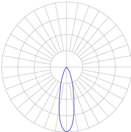
Luminária quadrada de embutir em forro de gesso, 2W 3000K IRC90. Corpo em alumínio. Acabamento branco. Controle óptico principal através de refletor + shade facho 25°. Luminária grau de proteção IP-20. Driver corrente constante Liga/Desliga Tensão de trabalho Bivolt.
